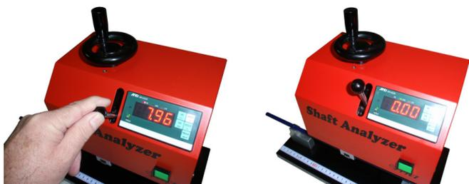
上部の丸ハンドルでセンターベアリングを下降させシャフトと接触させます。
